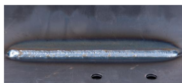
材质:2mm碳钢 电流: 130A 电压: 19.7V 焊接方式: 平角焊
