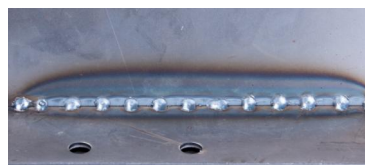
材质:2mm碳钢 电流: 115A 电压: 21.3V 焊接方式: 点焊
