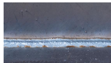
材质:10mm碳钢 电流: 310A 电压: 31.6V 焊接方式: 平角焊
