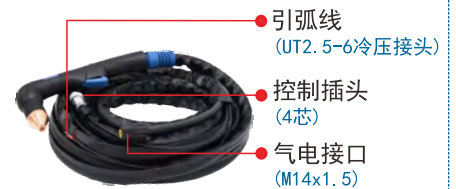
HYC-160BS1/HYC-160BS2 手工割炬（8米/10米线缆）
