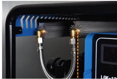
压缩空气冷却装置
