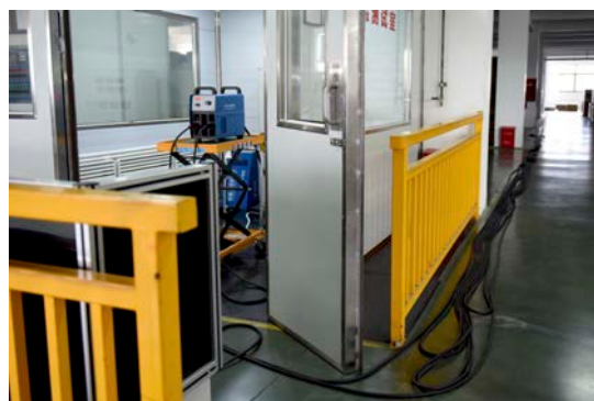
图示为加长300米50mm 2 焊接电缆焊接φ4.0焊条
